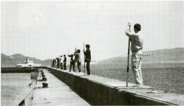
写真-5 原案天端高さに対する可視領域調査の様子
