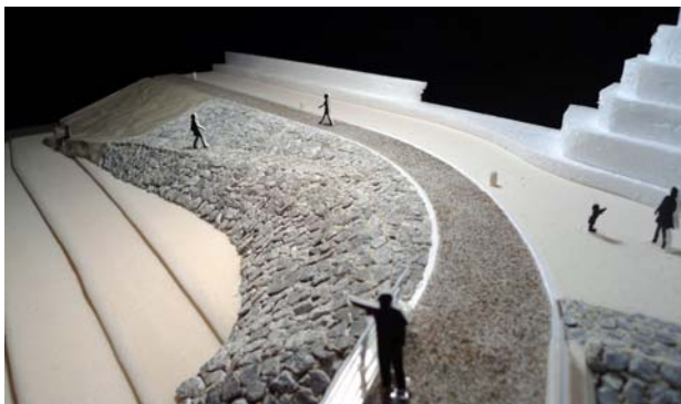
写真-2 陸域部の石積み護岸スロープ部 (1/50部分模型)
