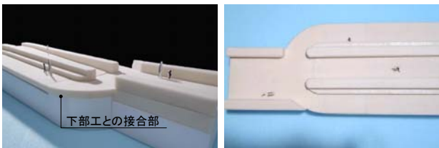
写真-8 外防波堤取付部 (1/50 部分模型)
