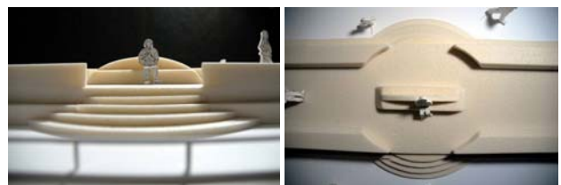
写真-5 外防波堤階段部（1/20部分模型）
