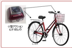
図1 小型アクションカメラの装着位置
