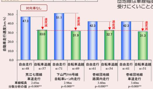
図11 自由走行時と自転車追越し時の自動車走行速度
