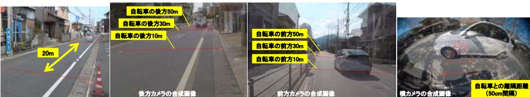
図4 自動車の走行速度を求める合成画像
